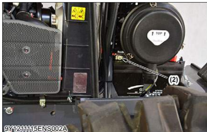
(2) Cực âm bình ắc quy
