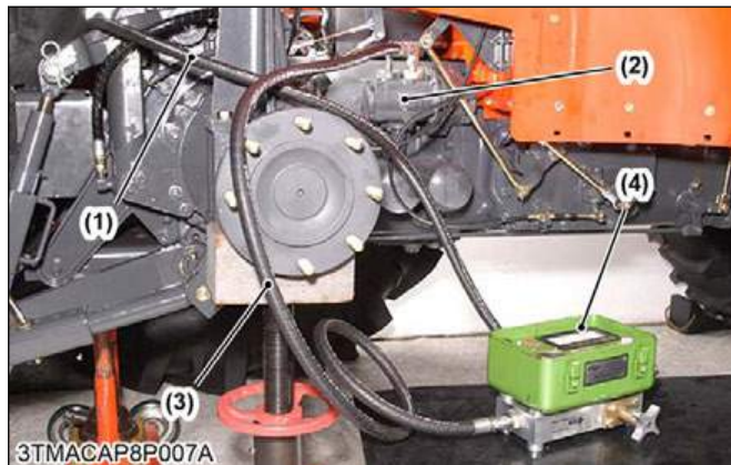
(1) Ống kiểm tra thủy lực (2) Bơm thủy lực (3) Ống kiểm tra thủy lực (4) Đồng hồ đo lưu lượng
