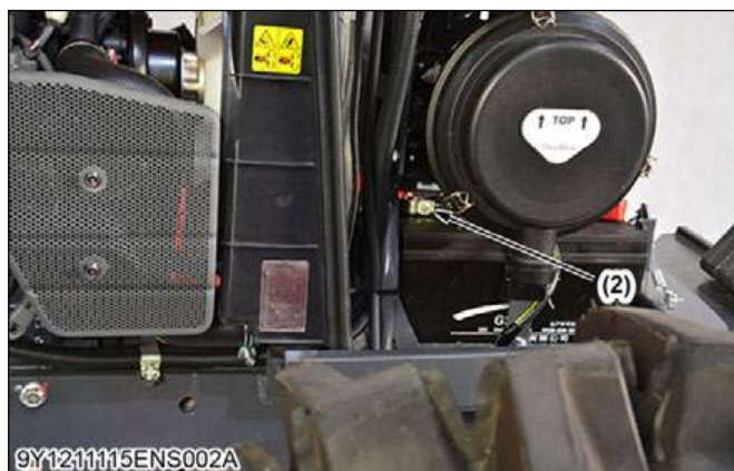
(2) Cực âm bình ắc quy
