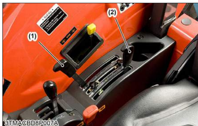
(1) Cần điều khiển vị trí (2) Cần điều khiển lực kéo
