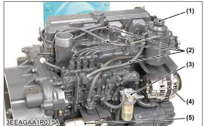
(1) Hộp lọc nhiên liệu (2) Ống dẫn nhiên liệu (3) Bộ đo cặn (4) Máy phát điện (5) Bộ khởi động
