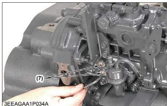
(7) Vít khóa trục cam nhiên liệu (Vít cố định để, loại điểm kẹp)
