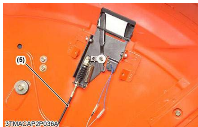
(1) Tấm chắn bùn (4) Cần nối dưới (2) Bánh sau (5) Cáp ly hợp PTO (3) Thanh nâng
