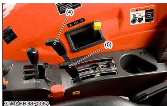
(4) Cần điều khiển vị trí (5) Cần điều khiển lực kéo
