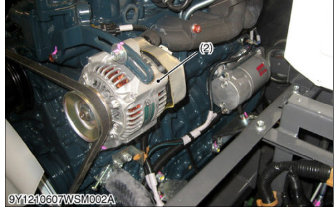
(1) Đèn báo nạp điện (2) Máy phát điện (Bộ điều chỉnh IC bên trong)
