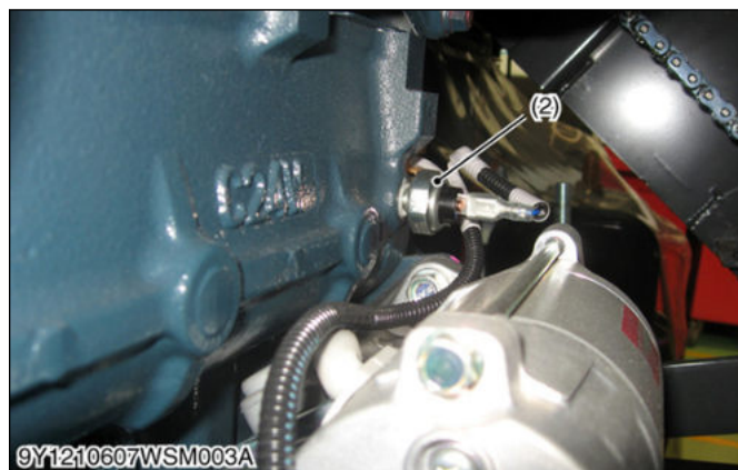
(1) Đèn báo áp suất nhớt động cơ (2) Công tắc áp suất nhớt động cơ
