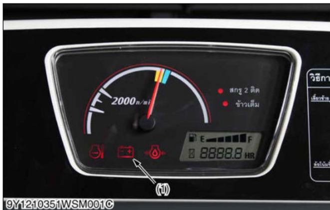
(1) Công tắc áp suất nhớt động cơ (2) Bảng thiết bị (3) Bíp báo hiệu cảnh báo
